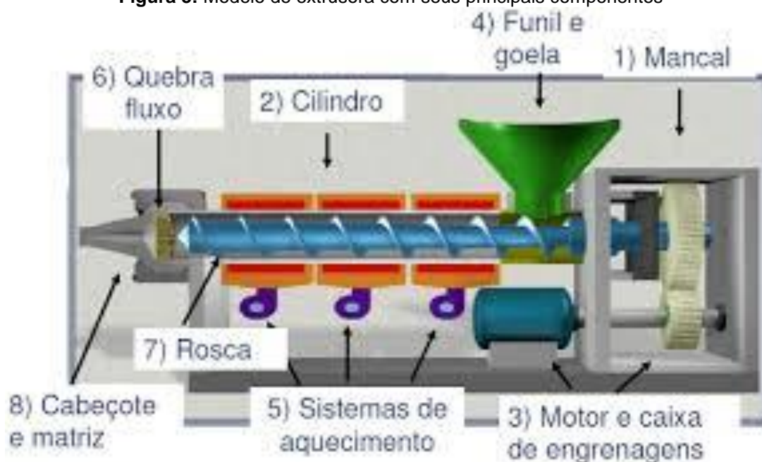
Figura 3: Modelo de extrusora com seus principais componentes
