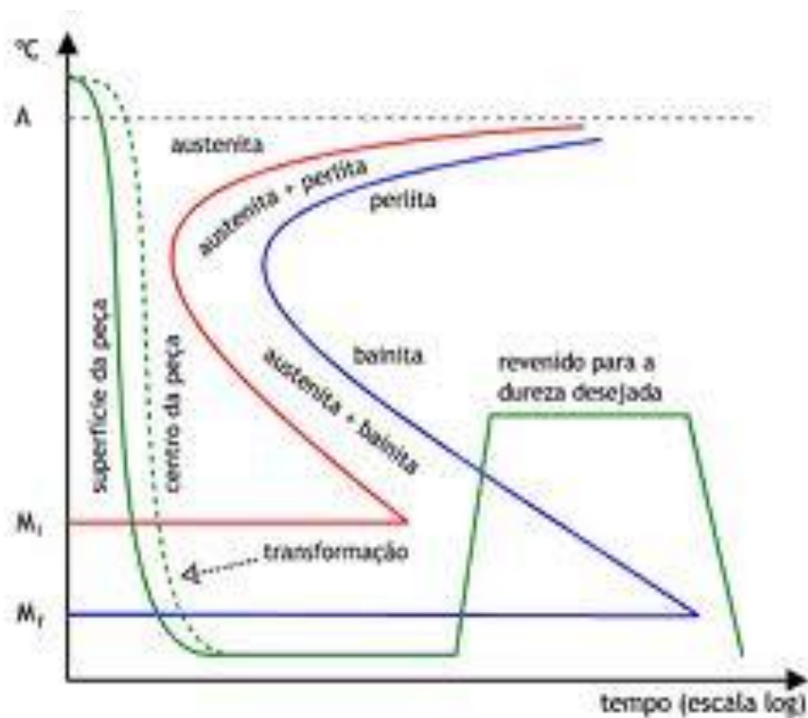
Figura 2 – Diagrama tempo – temperatura – transformação com linhas indicativas das etapas de tratamento térmico de têmpera e revenido de aços. O resfriamento é a parte esquerda da curva, isto é, da temperatura pouco acima de A até pouco abaixo de M f .
