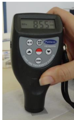
Figura 3 – Medidor de espessuras de camadas não-condutoras CM8825FN.Politem.
