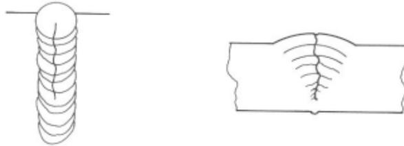
*Figura 15: trinca de solidificação*
