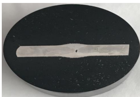
Figura 12: Macrografia Cordão de Solda Tecimento
