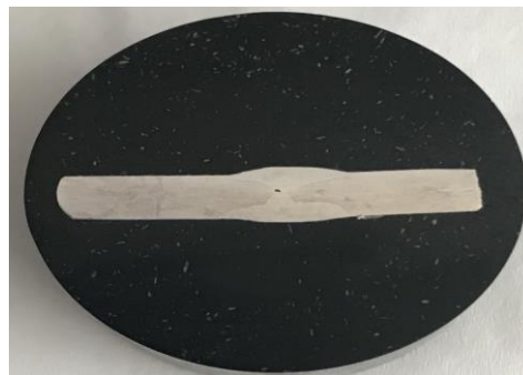
Figura 10: Macrografia Cordão de Solda Linear
