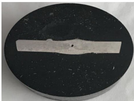
Figura 11: Macrografia Cordão de Solda Tecimento
